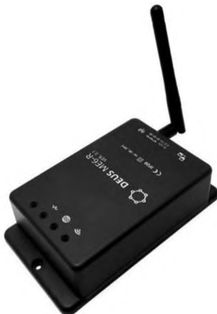
Рисунок 1 - МЕ6-R — устройство сопряжения беспроводной сети с облаком МЕ6Cloud
